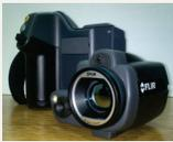
Esta es una cámara infrarroja. Registra escenas en luz IR y en visible de forma simultánea, tiene conectividad Wi-Fi, Bluetooth, brújula, GPS, conexión a PC... y pesa sólo 880 gramos, mientras que las de los años '60 ¡pesaban 80kg y tenían menos funciones!
