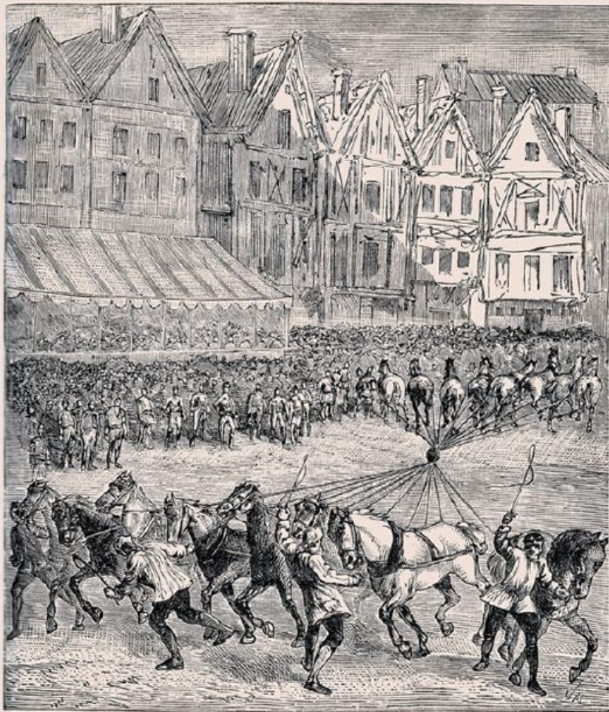
Expérience des Hémisphères de Magdebourg, exécutée par Otto de Guéricke devant l'empereur Ferdinand III, à la diète de Ratisbonne
