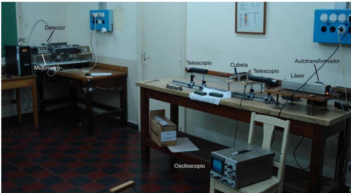
Figura 3. Fotografía de la configuración experimental donde se puede apreciar los elementos utilizados: PC, Detector, Multímetro, Telescopios, Cubeta, Láser, Autotransformador y Osciloscopio.
