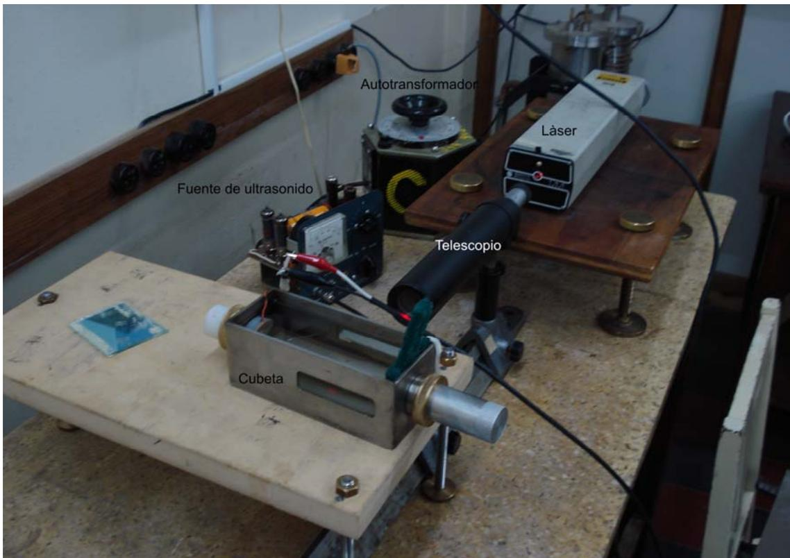
Figura 6. Vista detallada de la configuración experimental donde se puede apreciar el autotransformador, el láser, la fuente de ultrasonido, el telescopio y la cubeta.
