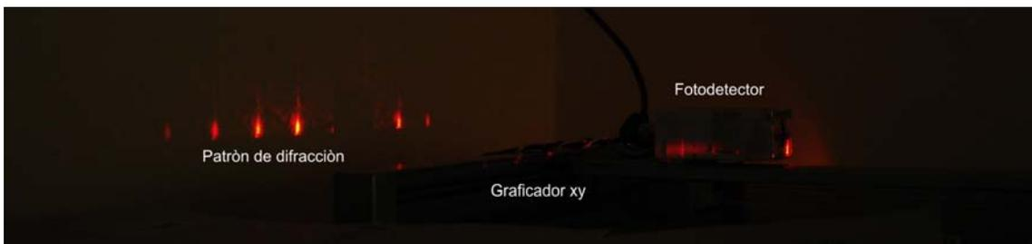
Figura 4. Fotografía del patrón de difracción y del fotodetector montado sobre el graficador xy.
