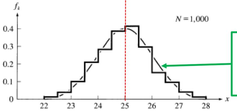
Tiende a una curva continua  $f(x)$  para  $N \rightarrow$  infinito: la distribución “normal” o de Gauss (*teorema central del límite*)
