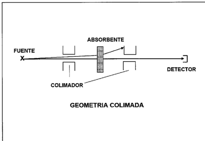
Con una geometría no colimada, la curva de transmisión ya no es una recta y la pendiente de la curva de transmisión aumenta con el espesor del absorbente. Esto se debe a que la radiación secundaria, que aumenta con el espesor del absorbente, enmascara la atenuación de la radiación original.
