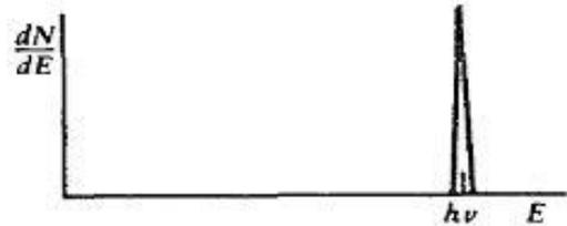
Figura 2: Distribución diferencial de la energía cinética del electrón para una serie de eventos fotoeléctricos. El único pico aparece a una energía total de electrones que corresponde a la energía de los rayos  $\gamma$  incidente.
